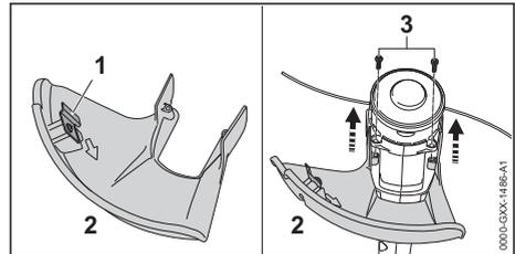
La cuchilla de acortar hilos (1) está ya montada en el protector (2) y no se permite desmontarla.
