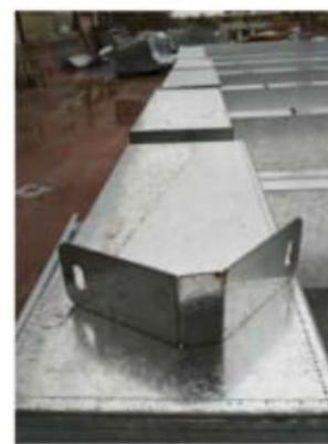
\* - Tensor de laterales; va de lateral a lateral, transversal al caño central.
