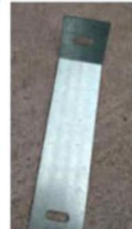
I Tensores alero lateral. El pliegue mas corto del tensor va al lateral y el otro al alero
