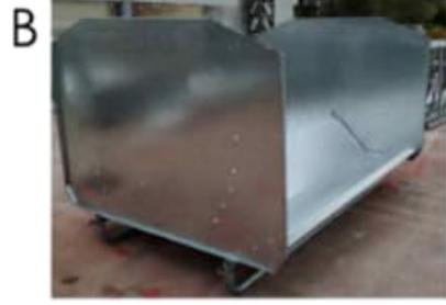
B - Cabecera; presentar la pieza con el pliegue hacia afuera y abulonar.
