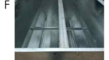
F - Tensor de Laterales va de lateral a lateral, transversal al caño central.
