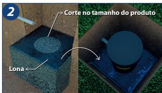
2. Instalar uma lona preta em torno da base da Câmara de lodo, impedindo que a terra do aterramento infiltre no meio da pedra brita. Porém, sem cobrir o fundo da Câmara, a fim de não obstruir a passagem do efluente líquido para a vala de infiltração. A lona tem o objetivo de impedir que a terra, areia ou pó de brita a ser utilizado no aterramento da câmara, percole e infiltre no meio do sistema de infiltração, causando o entupimento das britas.
