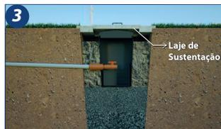
3. Caso o sistema seja instalado em local de intensa circulação (ou circulação de veículos), deve-se construir uma laje de sustentação que não seja apoiada no equipamento, além de manter fácil acesso à sua tampa de inspeção para eventual manutenção e limpeza do equipamento, cuja periodicidade deverá ser a cada 12 meses, ou inferior conforme necessidade de limpeza.
