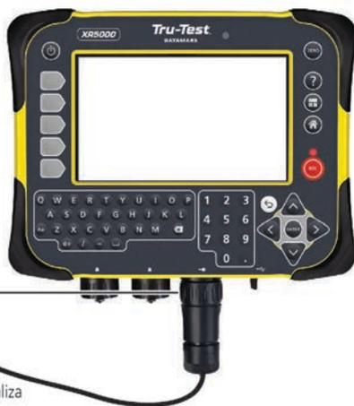
Una vez cargada la batería completamente, se visualiza el icono 'Batería cargada': Puede quitar el adaptador de red, si lo desea. El indicador podrá ser usado por 10 a 13 horas antes de que sea necesario recargar la batería.
